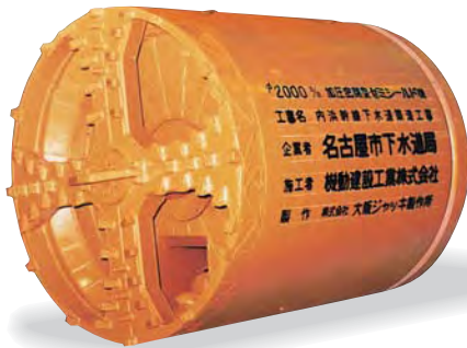
ヒューム管内径φ2000加泥式セミシールド
