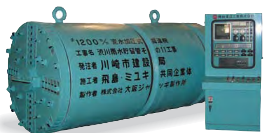
ヒューム管内径φ1200泥水加圧式セミシールド
