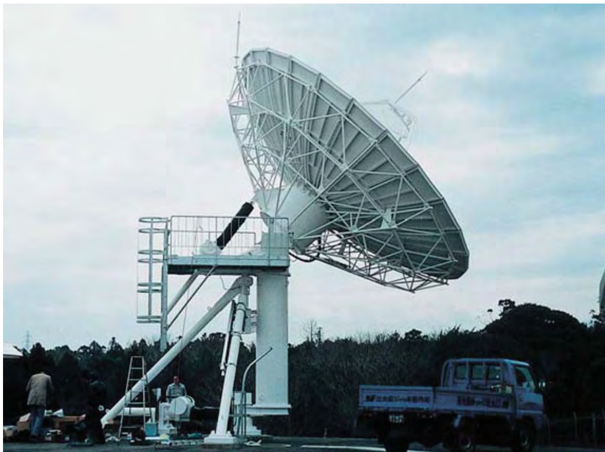
推力70kN 引力120kN×1850st パラボラアンテナの俯仰旋回作動用に使用
