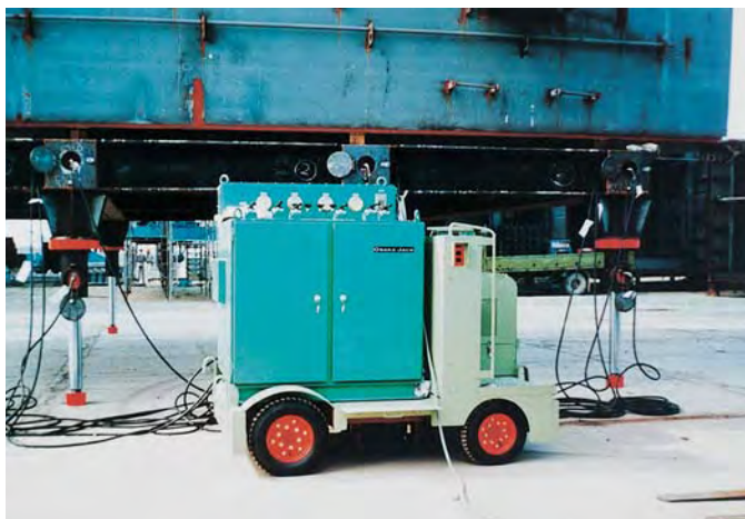
造船ブロックの台車昇降用 (300kN×800stパワージャッキ&シンクロポンプユニットを使用)
