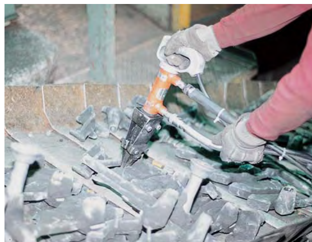
堰破碎機にて鋳物の湯道を破碎中 (AS-30K&GH2-Pを使用)
