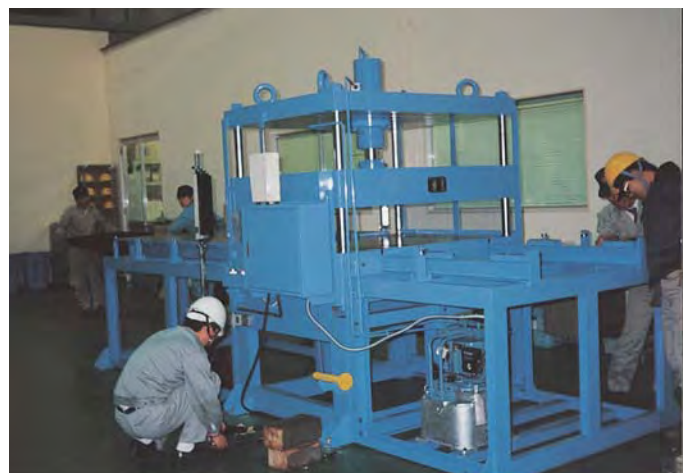
矯正プレス用(E50H15&電動ポンプを使用)
