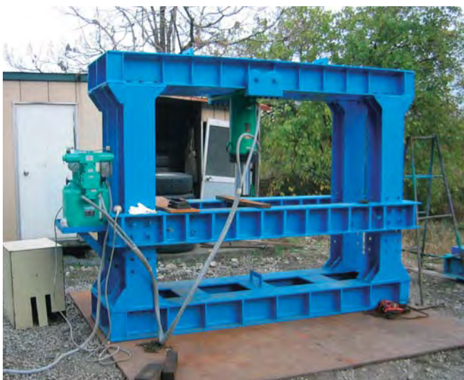
鉄板の矯正用 (E200H15&GH2-Pポンプを使用)
