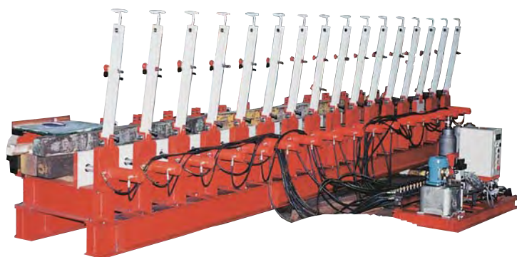
集成材圧縮装置用 (E10H15 16台&電動ポンプを使用)
