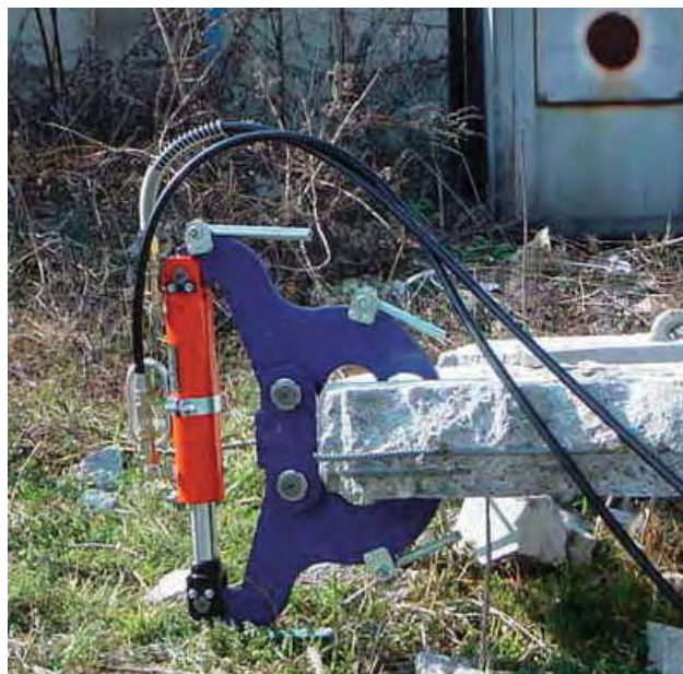
軽量形ハンディクラッシャ(チタン製ジャッキ) コンクリートの破壊中
